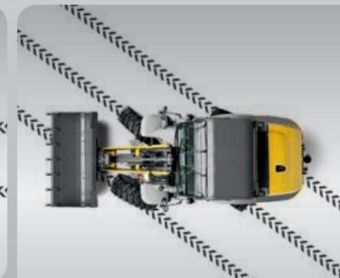
Hundeganglenkung: Die Hundeganglenkung ist ideal für Parallelfahrten und Manöver auf engstem Raum, z. B. beim Ausräumen von Hallen.
