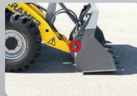
**Das Kramer Schnellwechselsystem:** An das Anbaugerät heranfahren. Vom Sitz aus und mit Sichtkontakt das Anbaugerät hydraulisch aufnehmen. Per Tastschieber am Joystick verriegeln.
