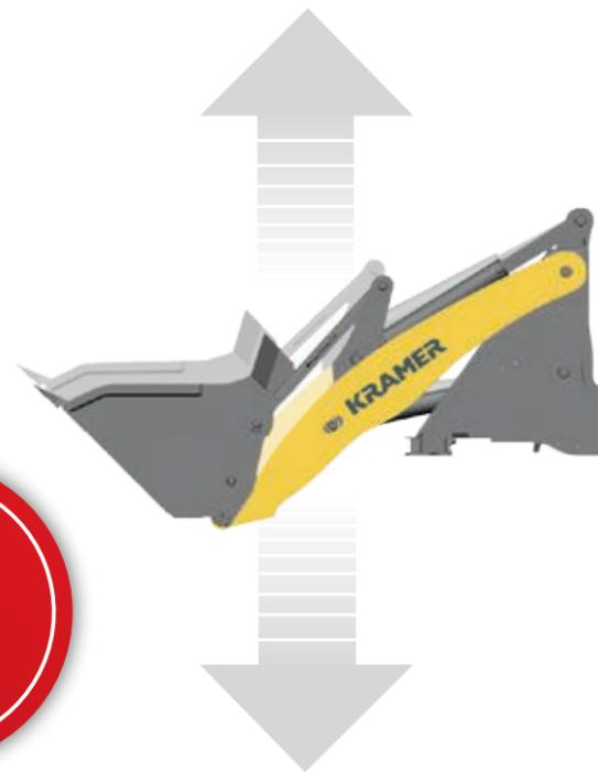
**Schont Mensch und Maschine:** Der Laststabilisator dämpft Schwingungen der Ladeanlage bzw. der Last ab und sorgt somit bei höheren Geschwindigkeiten für ein mehr an Fahrsicherheit und -komfort.
