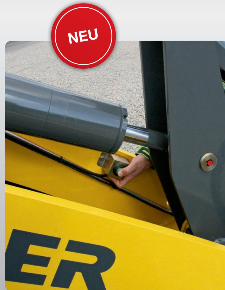
**Druckentlastung im 3. Steuerkreis** – für einfaches An- und Abkoppeln von Anbaugeräten mit hydraulischen Zusatzfunktionen.
