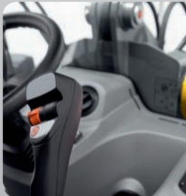
**Feinfühliges und präzises Steuern** von Maschine und Anbaugerät per mechanisch vorgesteuertem Joystick.
