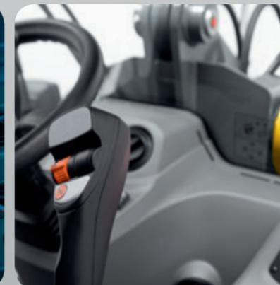
**Feinfühliges und präzises Steuern** von Maschine und Anbaugerät per mechanisch vorgesteuertem Joystick.
