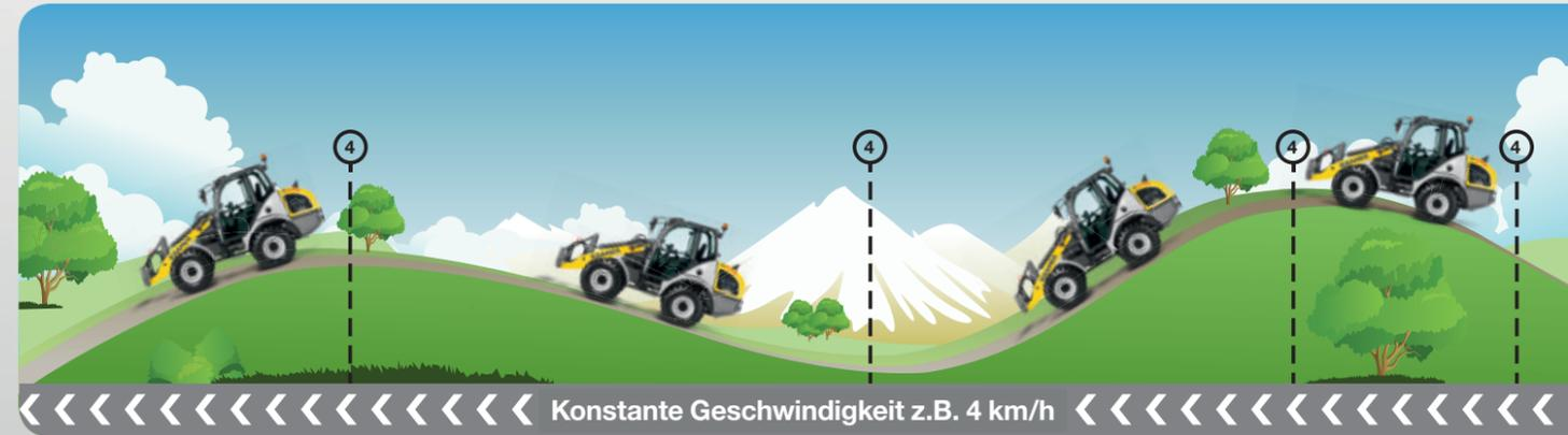
Bei der Verwendung von Anbaugeräten, die beispielsweise mit konstant hoher Drehzahl aber gleichzeitig mit sehr niedriger Fahrgeschwindigkeit betrieben werden (z.B. einer Kehrmaschine), können eben diese Vorgaben von der Langsamfahreinrichtung in Verbindung mit dem Handgas gleichzeitig realisiert werden. Die Geschwindigkeits- und Drehzahlregelung über die Fußpedale entfällt, der Fahrer wird entlastet.
