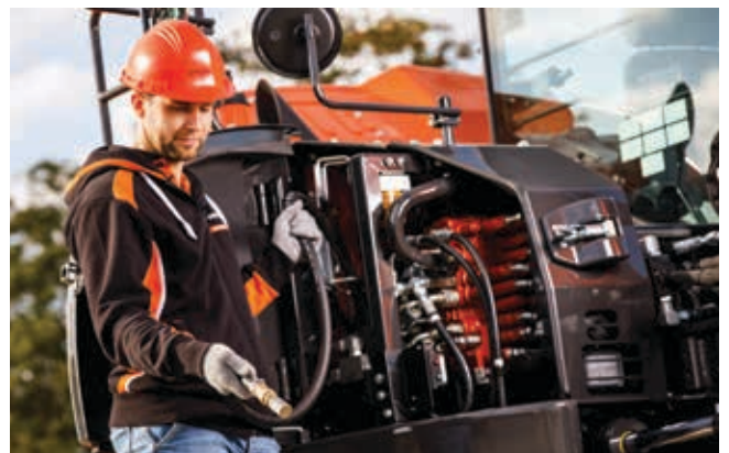
Der Bagger kann mit einer elektrischen Pumpe betankt werden.
